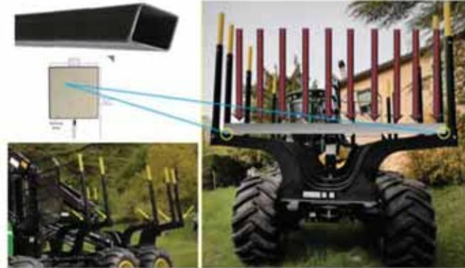
posizionamento dei sensori di pesatura "flexiforce A502" sul telaio della macchina forestale forwarder
